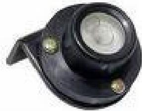
Nivela esférica para definir um plano horizontal, que permite, por construção, verticalizar a mira
